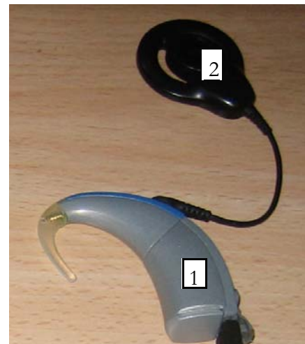
Componentes externos de un implante coclear moderno: 1- Procesador externo; 2- transmisor de la información. Hay modelos en que el procesador (1) va colgado en una “petaca”.
